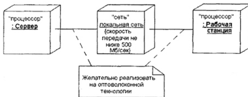
Рисунок 1. Фрагмент диаграммы развертывания с соединениями между узлами
